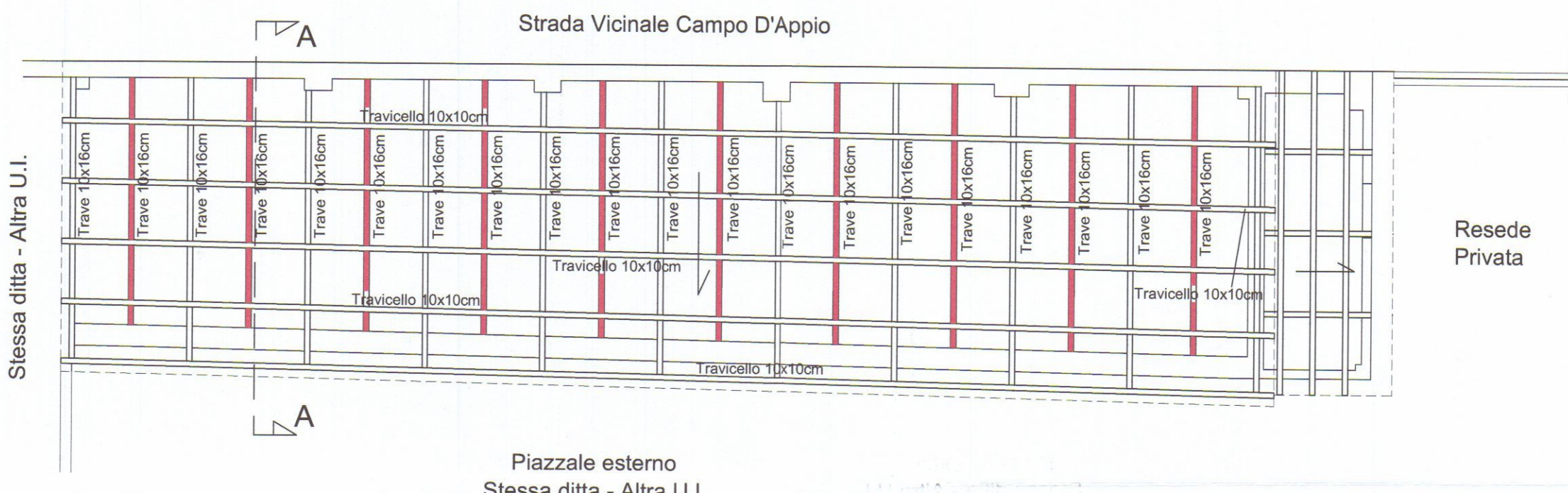
PIANTA STRUTTURA COPERTURA
