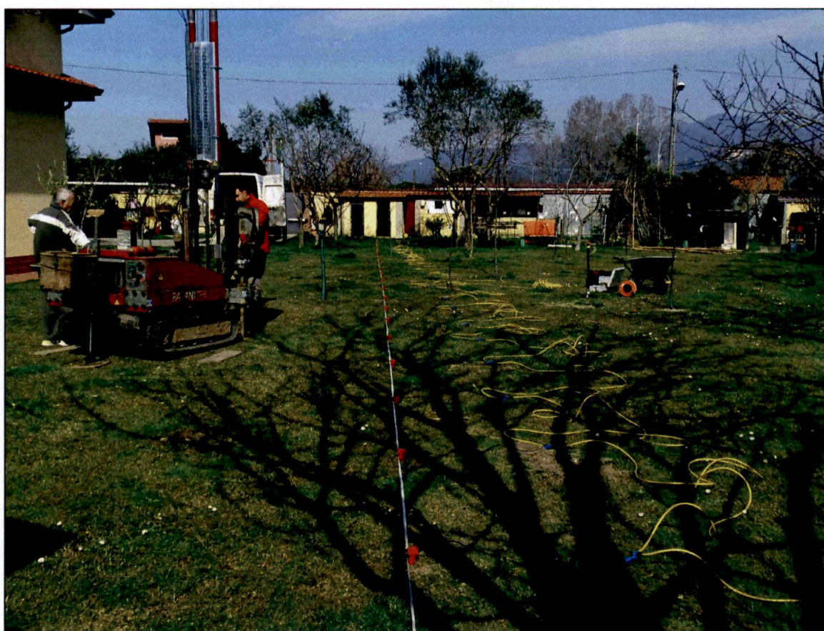
Figura 2 - Stendimento sismico per acquisizione MASW e indagine penetrometrica.
