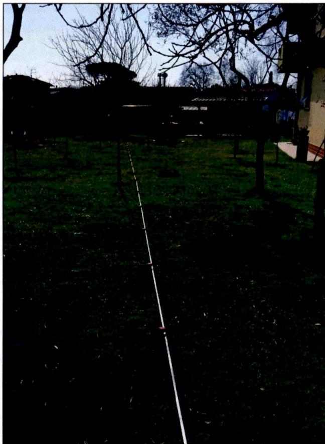
Figura 1 - Stendimento sismico per acquisizione MASW
